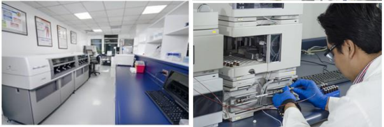
Fotografía 4 Preparación de las muestras para cuantificación de capsaicinoides en HPLC.
