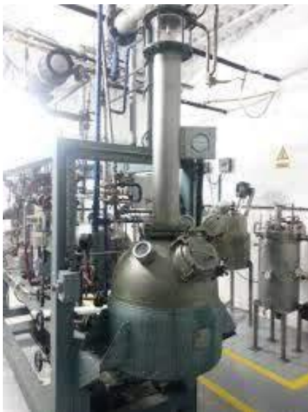
Fotografía 5 Extracción de oleorresina en planta piloto, LIEXVE, FII, USAC.
