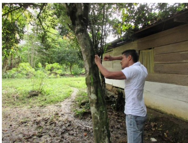
Fotografía 3: Instalación de sensores de humedad relativa y temperatura, en la comunidad Limón Sur, Chisec, A.V.
