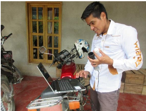
Fotografía 6: Descarga de datos de los sensores (HOBO), para la medición de humedad relativa y temperatura, La Tuería.
