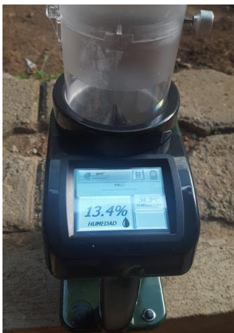
Fotografía 8. Medidor de humedad para las muestras seleccionadas de maíz.
