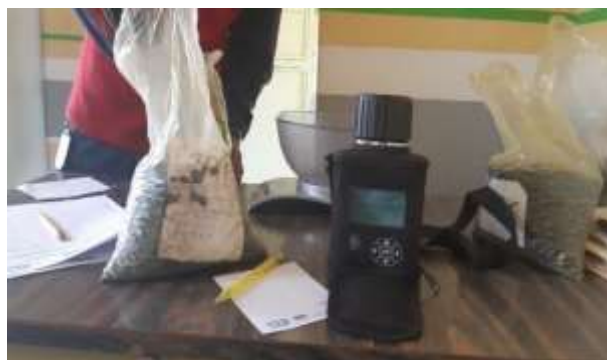
Fig. 14 Toma de humedad.
